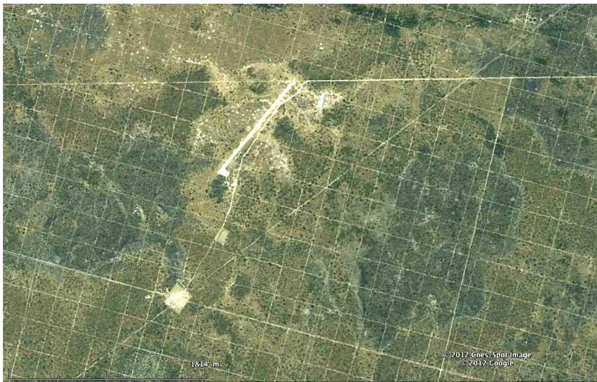
Fig. 52 - Le centre de la grille d'arpentage préluant à l'installation des plateformes des puits de pompage du pétrole. On distingue une plateforme d'expérimentation et une piste d'aviation.
