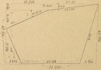
Enfin on vérific les angles et les côtés calculés en calculant les coordonnées des divers sommets sur la grande base 65.92. Si le polygone est exact on doit avoir les égalités (37.384 + 6.484) = (45.973 - 2.106) 37.384 + 6.484 + 2.106 = <math>45.974 (33.766 + 39.53) = (65.92 + 3.832 + 3.544).
